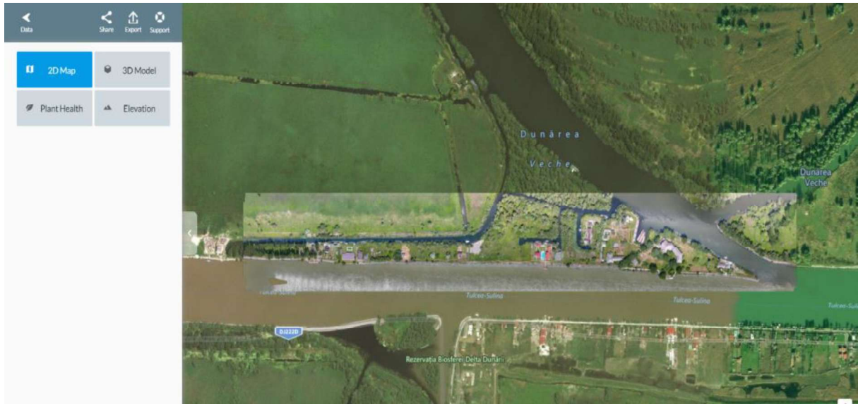
Figura 35. Ortophotoplanul obținut în urma unui zbor la 100 în zona Braș Sulina - Dunărea Veche – Crișan. Se observă gradul de detaliu superior obținut față de cel al imaginii Google Map peste care este suprapus rezultatul zborului și prelucrat cu ajutorul platformei online https://www.dronedeploy.com
