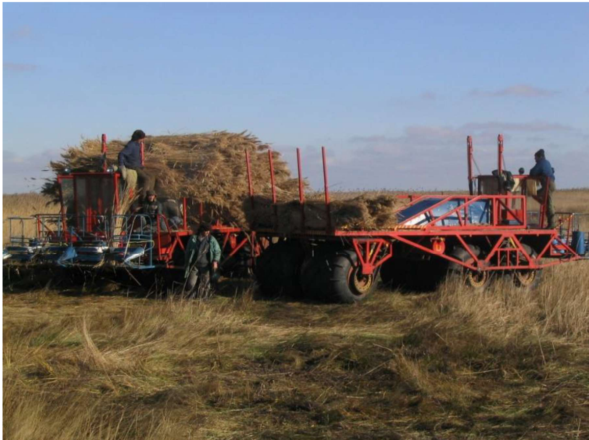
Figura 45. Recoltarea mecanizată cu utilaje cu presiune specifică
