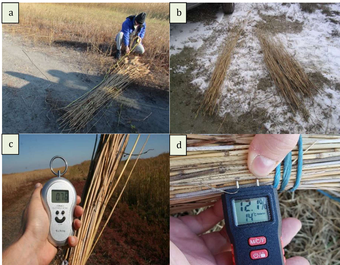
Figura 33a. Etapele cartării și evaluării în teren a stufărișurilor: (a) măsurarea lungimii tulpinilor (maximă și minimă); (b) separarea tulpinilor de stuf pe generații (stuf verde și uscat); (c) cântărirea stufului verde; (d) măsurarea umidității tulpinilor
