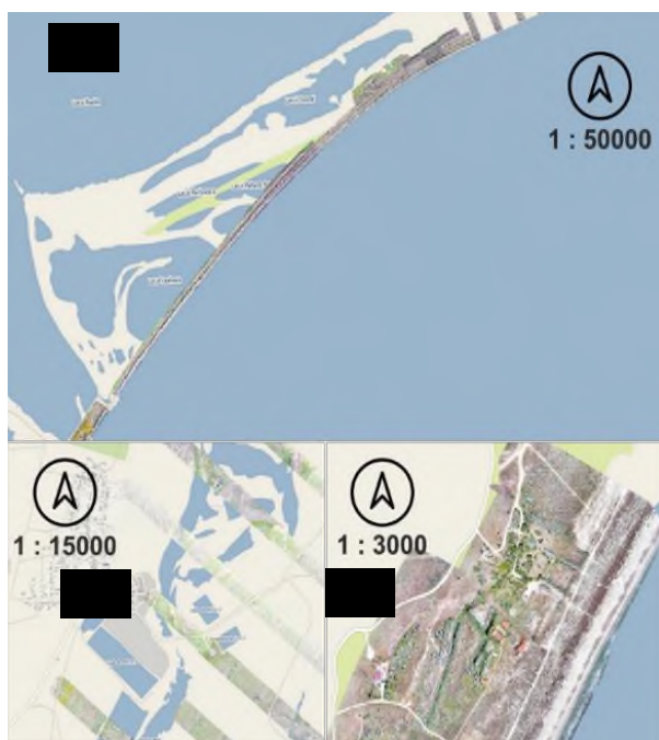
Figura 9.32. Imagini mozaicate în urma procesării ale fotografiilor provenite din dronă. (a) aproximativ 22 de zboruri formează această imagine mozaicată, (b) profile perpendiculare pe zona costieră în dreptul localității Vadu. (c) imagine mozaicată în detaliu pentru zona litorală Midia Nord.
