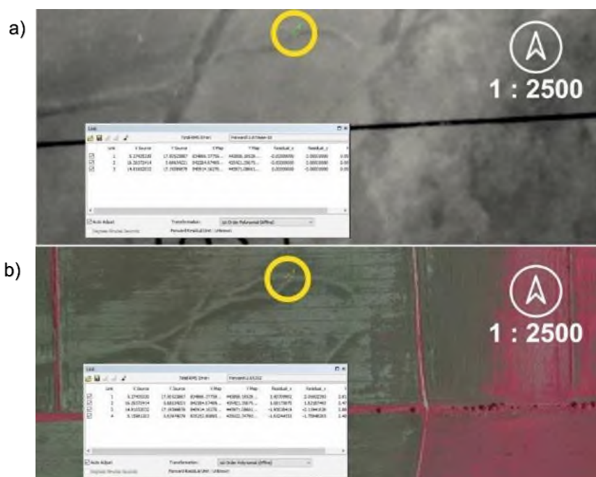
Figura 9.23. Procesul de georeferențiere: (a) imaginea scanată trasă în coordonate, (b) imagine ortofoto după care se realizează georeferențierea
